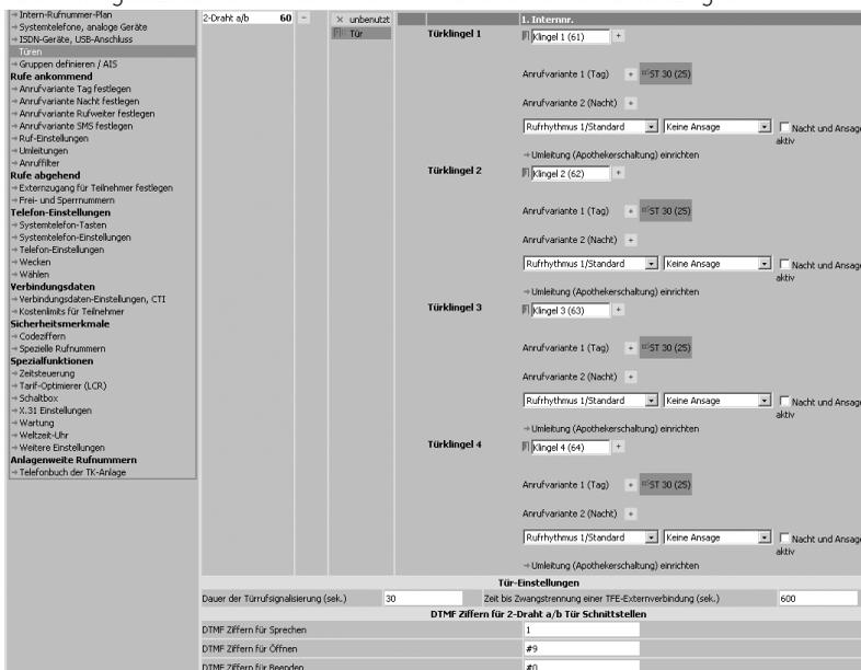
Geben Sie ein, wie lange ein Türruf auf Ihren Telefonen signalisiert werden soll und wie lange eine Verbindung nach extern bestehen soll, bis eine Zwangstrennung erfolgt. Stellen Sie bitte sicher, dass die max. Rufzeit in der TFE immer kleiner ist als die Einstellung in der TK-Anlage! Andernfalls ist beim Auslösen des Rufes von der TK-Anlage der Besetztton im Lautsprecher Ihrer TFE für die verbleibenden Sekunden zu hören !
