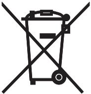
Die auf dem Produkt angebrachte durchkreuzte Mülltonne bedeutet, dass das Produkt zur Gruppe der Elektro- und Elektronikgeräte gehört.
