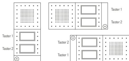
Montagevariante und Tastenbelegung mit 1 Taste
