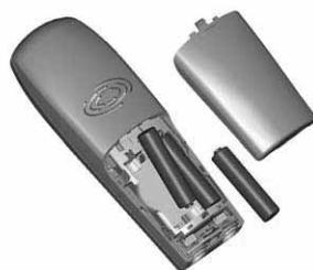
Verwenden Sie nur geprüfte, wiederaufladbare Akkus. Um beim erstmaligen Laden eine optimale Ladung zu gewährleisten, lassen Sie das Mobilteil mindestens 6 Stunden in der Basis. Während des Ladevorganges kann es zu einer Erwärmung der Akkus kommen. Das ist normal und nicht gefährlich.
