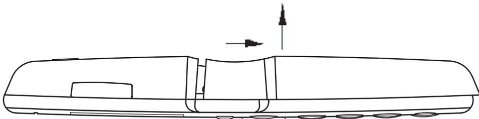
Um die Abdeckklappe des Akkus zu öffnen, drücken Sie diese mit dem Daumen zu den Ladekontakten hin und heben Sie die Abdeckklappe dann vom Gerät ab.
