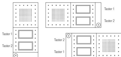
Montagevariante und Tastenbelegung mit 1 Taste
