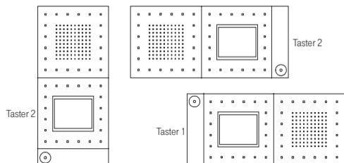
Montagevariante und Tastenbelegung mit 3 oder 4 Tasten
