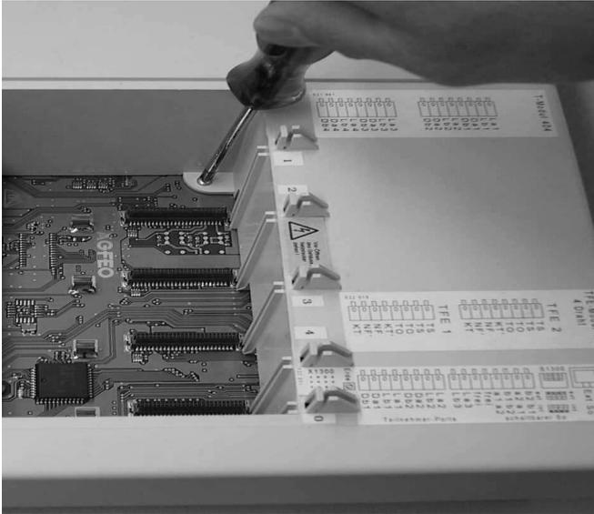
2. Schritt: Öffnen Sie den Deckel der AS 40, AS 40P, indem sie die Rastnasen an der Deckeloberkante eindrücken und dann den Deckel abheben.
