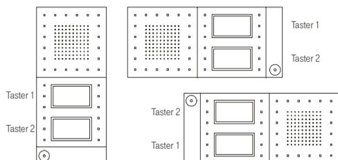
Montagevariante und Tastenbelegung mit 1 Taste
