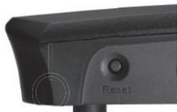
Um die DECT IP-Basis XS in den Auslieferungszustand zurückzusetzen, halten Sie den Reset-Schalter für mindestens 10 Sekunden gedrückt, bis die Status-LED dauerhaft rot leuchtet.
